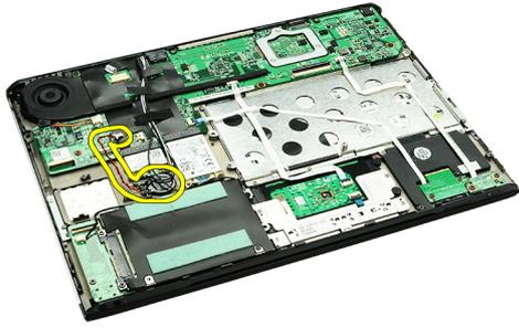
2. 시스템 보드에 코인 셀 배터리 케이블을 연결합니다.
