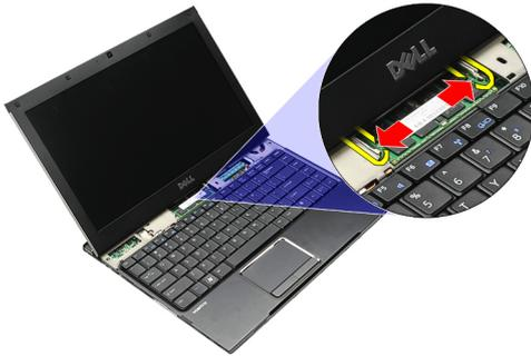
4. 시스템 보드에서 45도 각도로 메모리 모듈을 잡아당겨 시스템 보드의 커넥터에서 메모리 모듈을 분리합니다.
